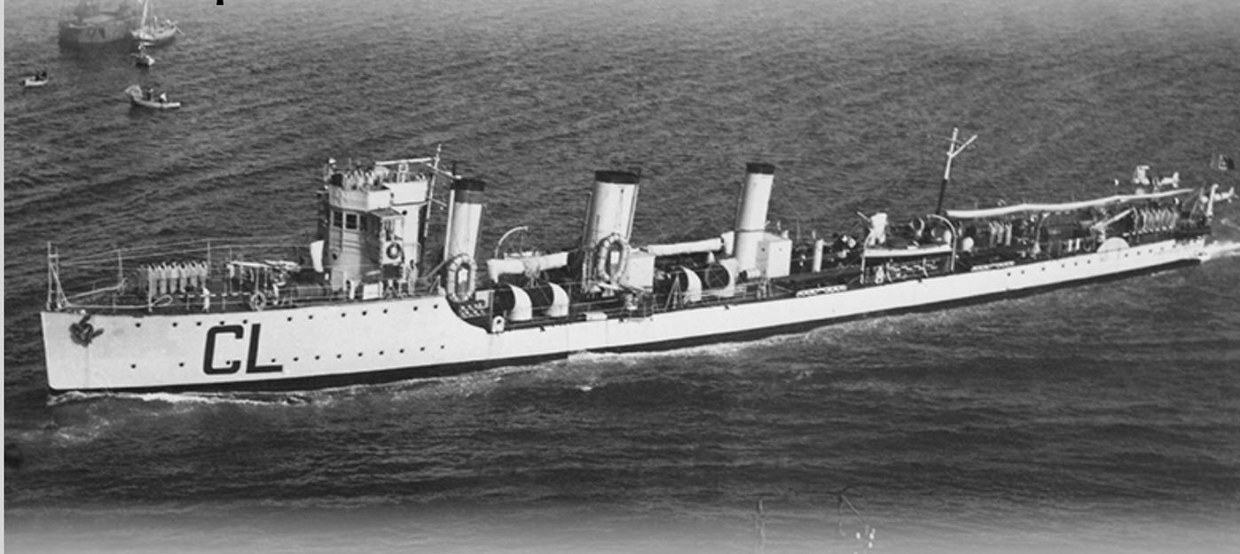
Torpediniera, già cacciatorpediniere, appartenente alla classe Rosolino Pilo (dislocamento in carico normale 770 tonnellate, a pieno carico 806 tonnellate) della numerosa serie detta dei "tre pipe". Ex Francesco Nullo.
